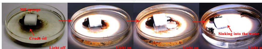
圖 S8、光照關閉/開啟條件下，MF 海綿在海水表面的原油吸收過程。
