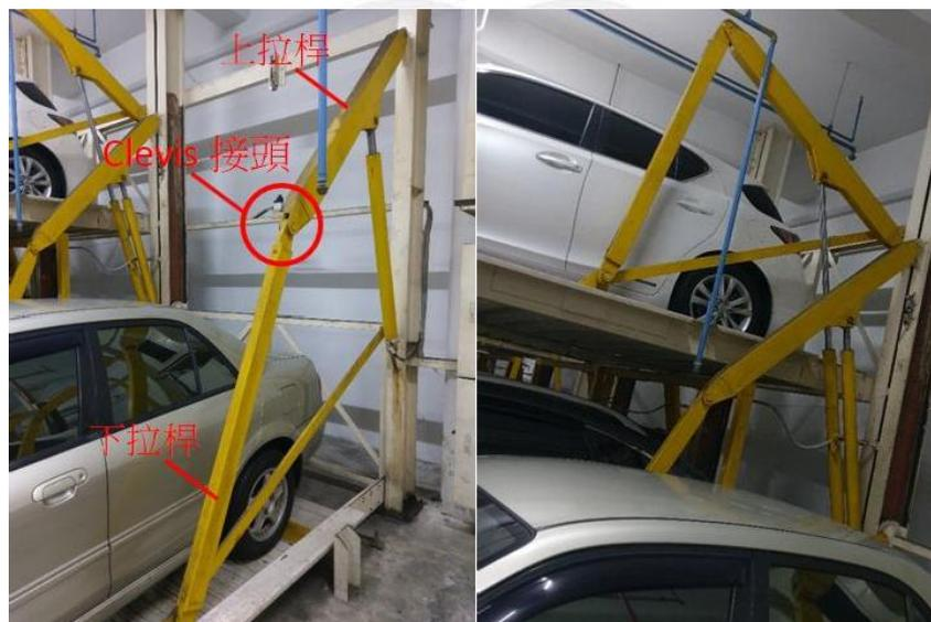
圖 1.1 兩段式拉桿式機械停車位
