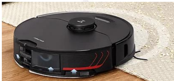
圖 3、拖布抬升示意圖(來源: Roborock S7 MaxV Ultra[5])
