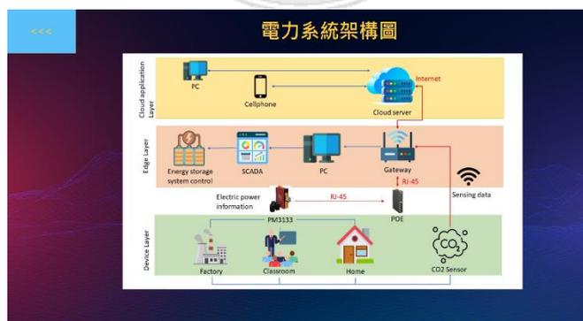
圖 5.系統架構\_電力
