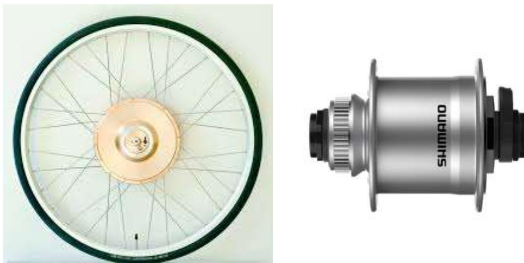
圖 3：電磁式能量收集裝置照片圖
