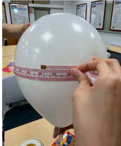
圖 9 控制因子 C (氣球充氣體積) 之量測
