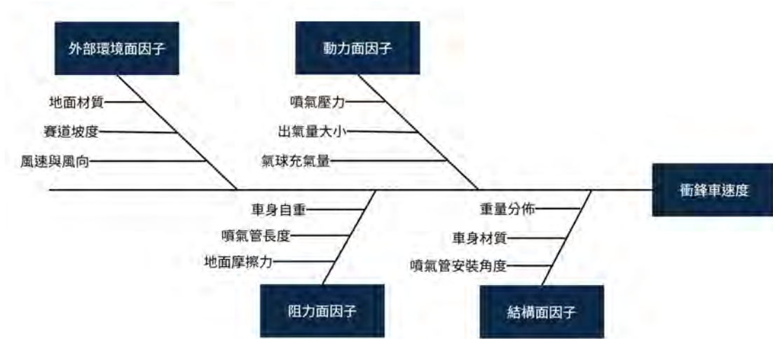
圖 8 氣球衝鋒車速度特性要因圖（魚骨圖）
