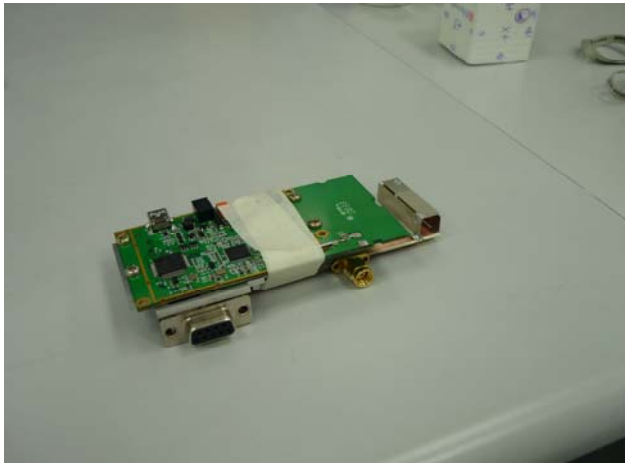
圖 15 天線置於讀取器上進行實測
