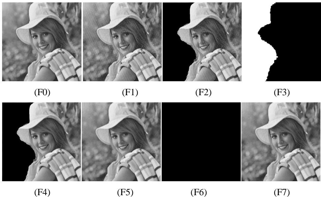
圖九：(F0)原影像 (F1)嵌入影像 PSNR=27.9589 (F2)篡改影像 PSNR=10.3466 (F3)偵測篡改區塊 (F4)無失真還原未篡改區塊 PSNR=10.3991 (F5)修復篡改區塊 PSNR=33.5652 (F6)尚未修補區塊 (F7)修補遺失回復資訊之篡改區塊 PSNR=33.5652。
