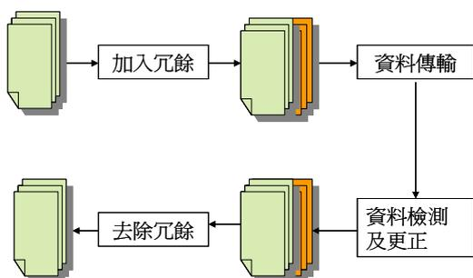
常用到的錯誤更正編碼有漢明碼 (Hamming Code)，以漢明碼 (7,4) 為例，資料長度為 4 bits，編碼後的長度為 7 bits，也就是加了 3 bits 的資料冗餘，此 (7,4) 編碼可以更正 1 bit 錯誤。例如假設資料為 1011，經漢明碼編碼後的資料為 1011010。
