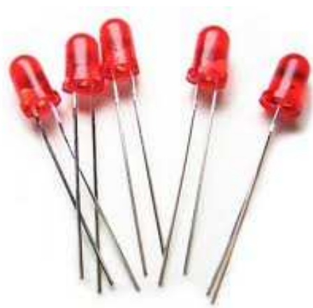
圖 2.9 LED，圖為發紅光的發光二極體
