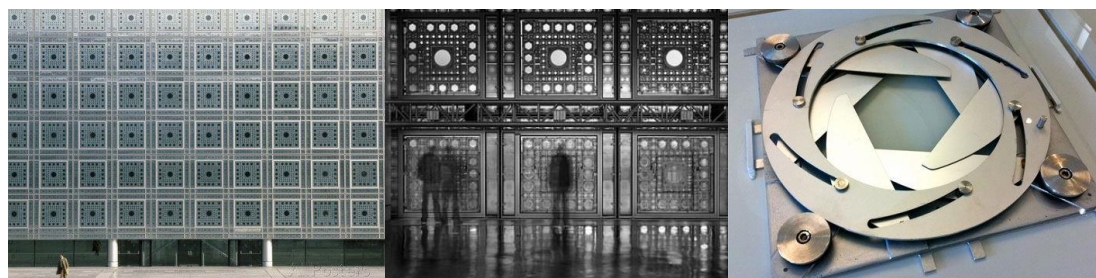
圖 五 巴黎設計的阿拉伯文化中心 ( Institut du Monde Arabe ) 的控光裝置
