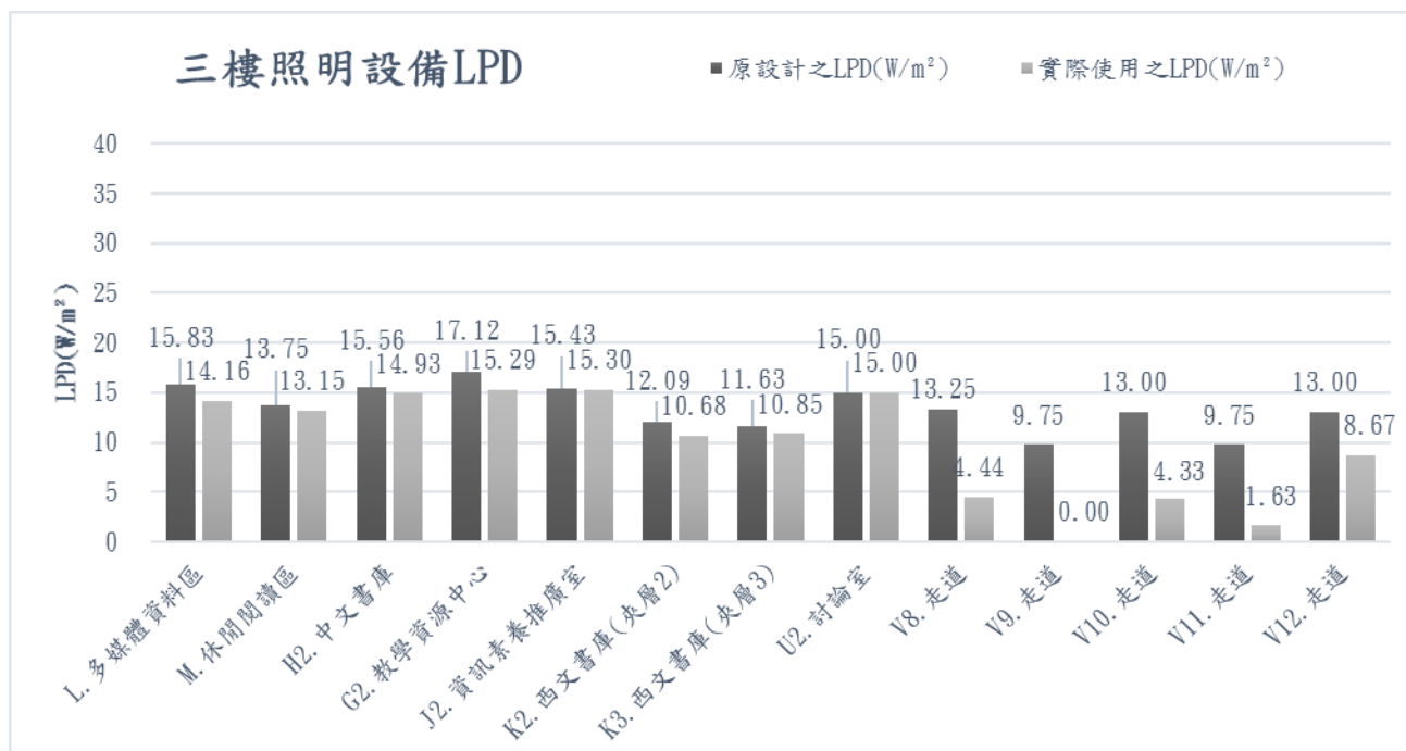
圖 2.3 三樓照明設備 LPD
