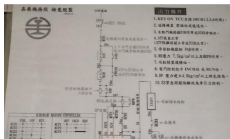
圖 17 嘉義機務段不出力檢查表供司機員故障排除
