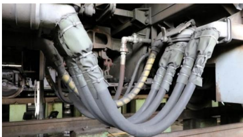
圖 16 EMU600 型 79 芯跳線(包覆塑膠避免水滲)
