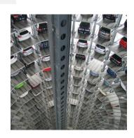
1.節省空間: 一個車位的建築面積 36-40 平方米,機械式車庫一般為 3-18 平方米,相同占地面積的機械車庫可增加車位 2-13 倍。
