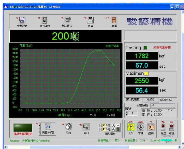
圖 二十五 5x5x5 公分實心立方試體(一)抗壓結果
