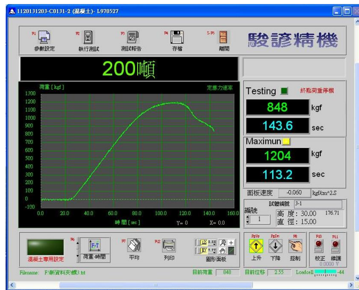
圖六十七 4x4x30 公分螺旋試體(三)抗壓數據
