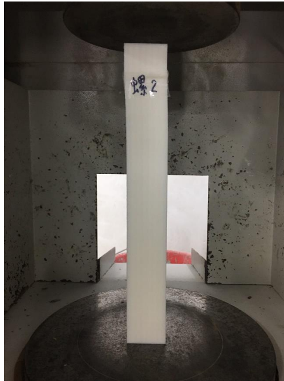
圖 六十六 4x4x30 公分螺旋試體(二)破壞形態
