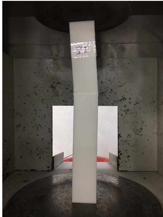
圖 四十五 4x4x30 公分空心試體(一)破壞形態
