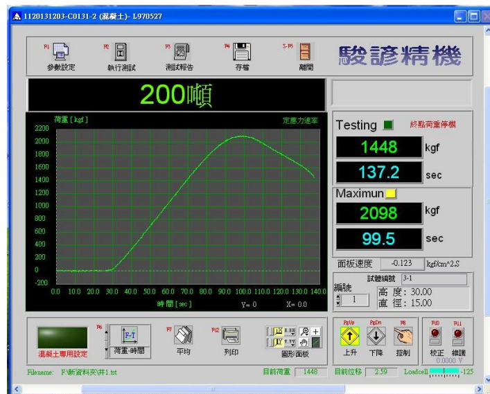
圖 五十二 4x4x30 公分井字試體(一)抗壓數據
