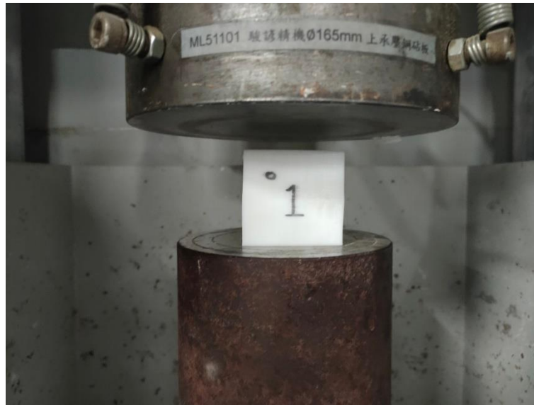
圖 三十六 5x5x5 公分空心立方試體(一)破壞形態
