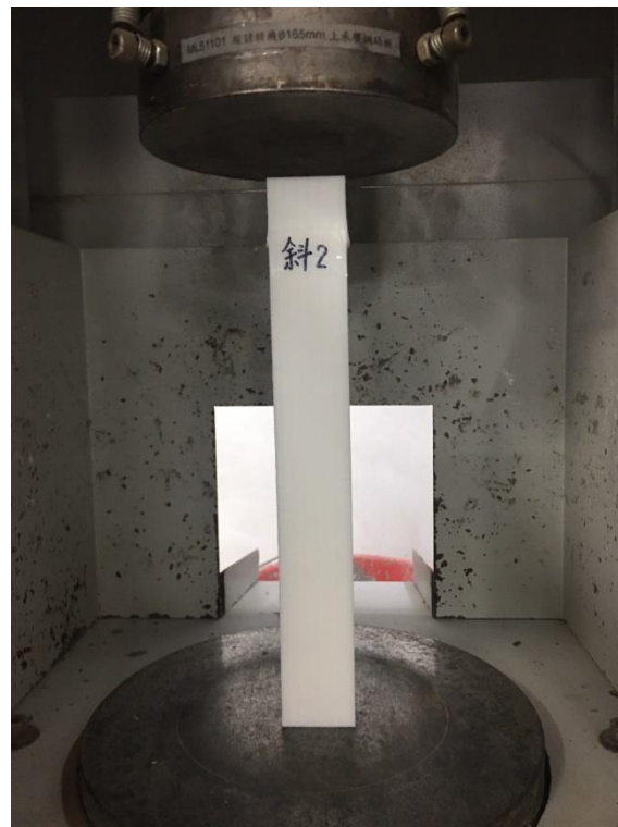
圖 七十五 4x4x30 公分斜撐試體(二)破壞形態
