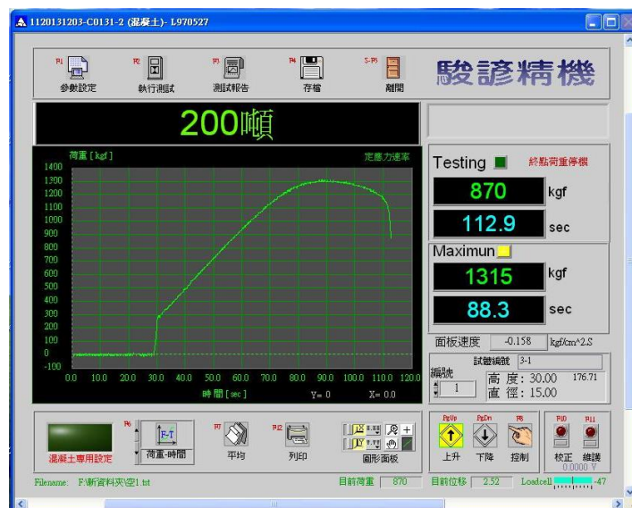
圖 四十三 4x4x30 公分空心試體(一)抗壓數據
