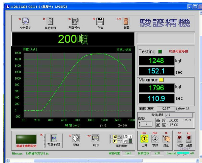
圖 五十八 4x4x30 公分井字試體(三) 抗壓數據
