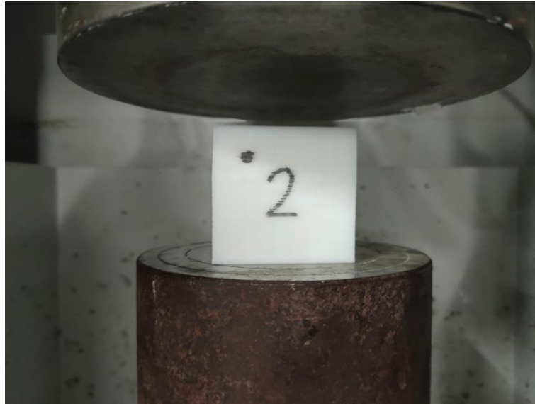
圖三十 5x5x5 公分實心立方試體(二)破壞形態
