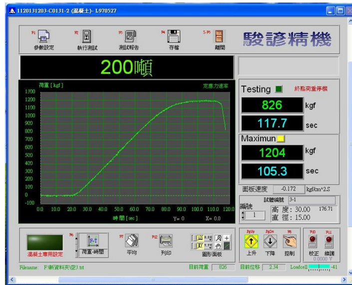
圖 四十九 4x4x30 公分空心試體(三) 抗壓數據
