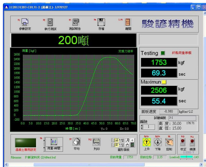
圖二十八 5x5x5 公分實心立方試體(二)抗壓結果
