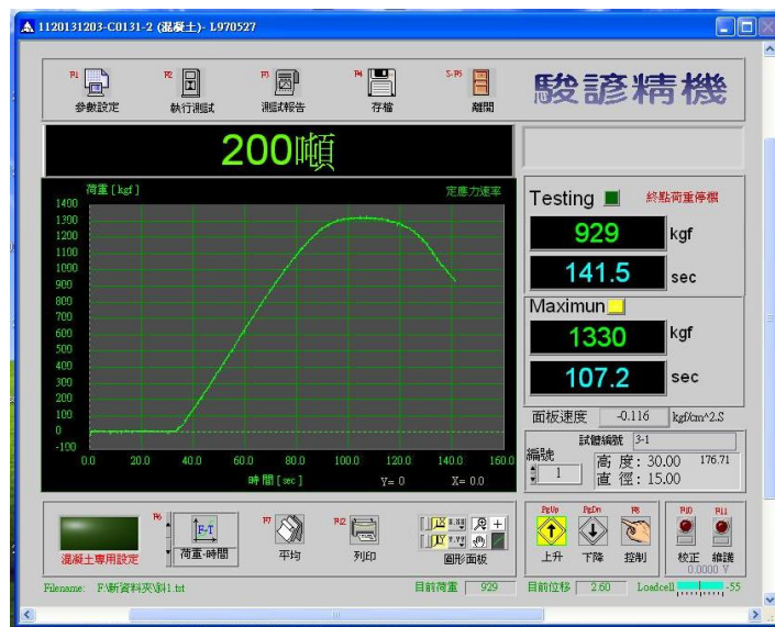
圖 七十 4x4x30 公分斜撐試體(一)抗壓數據
