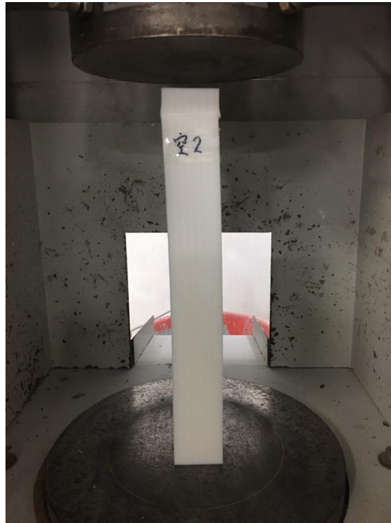
圖 四十八 4x4x30 公分空心試體(二)破壞形態
