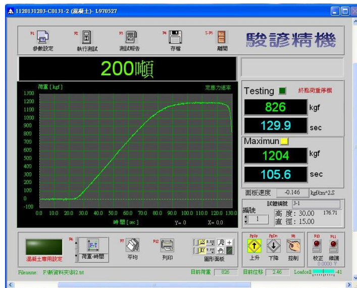
圖 七十三 4x4x30 公分斜撐試體(二)抗壓數據
