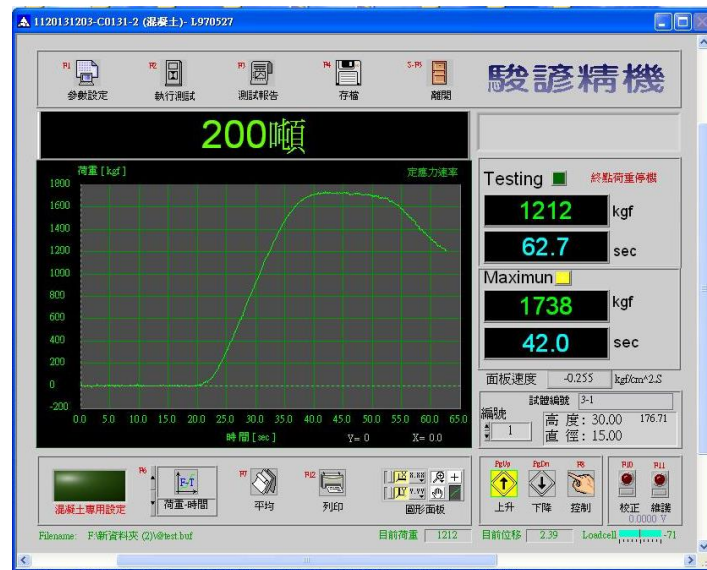
圖 四十 5x5x5 公分空心立方試體(三)抗壓結果
