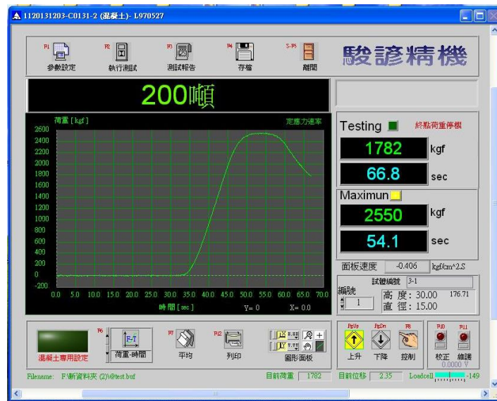
圖 三十一 5x5x5 公分實心立方試體(三)抗壓結果
