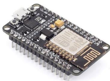
(圖 1 - NodeMCU 開發板)
