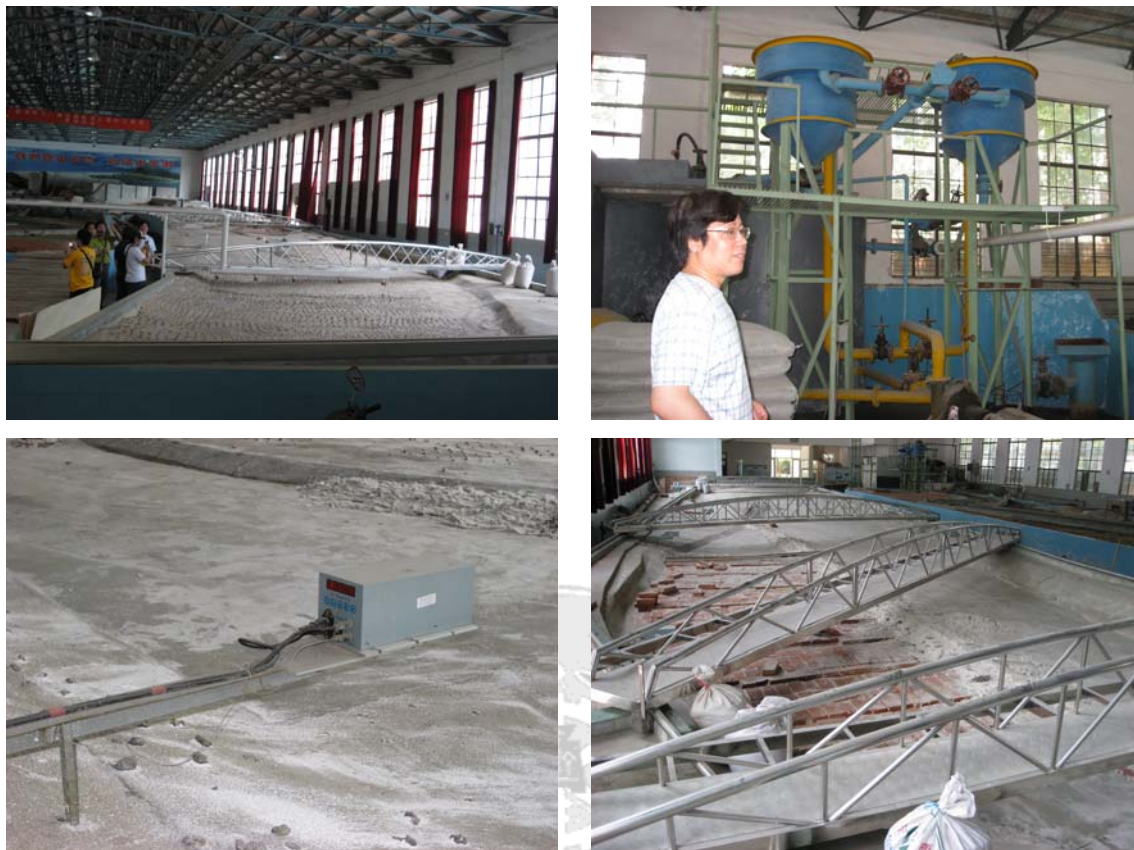
照 2 泥沙模型試驗
