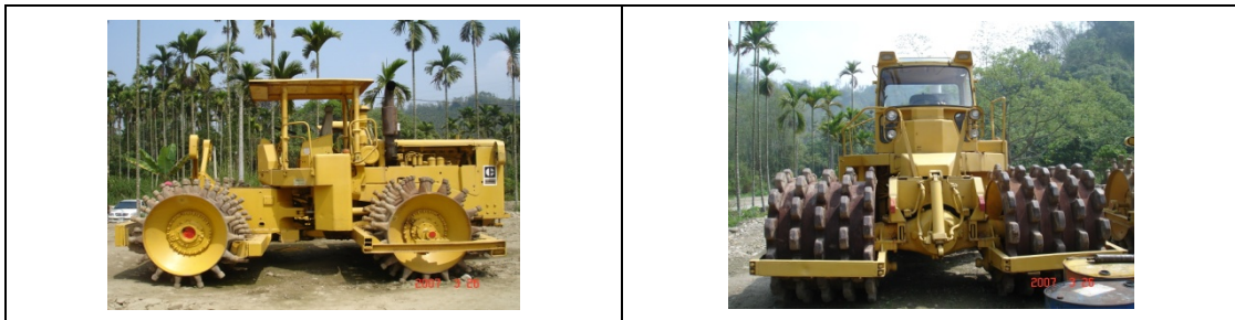
圖 2-10 壩體填築滾壓機具
