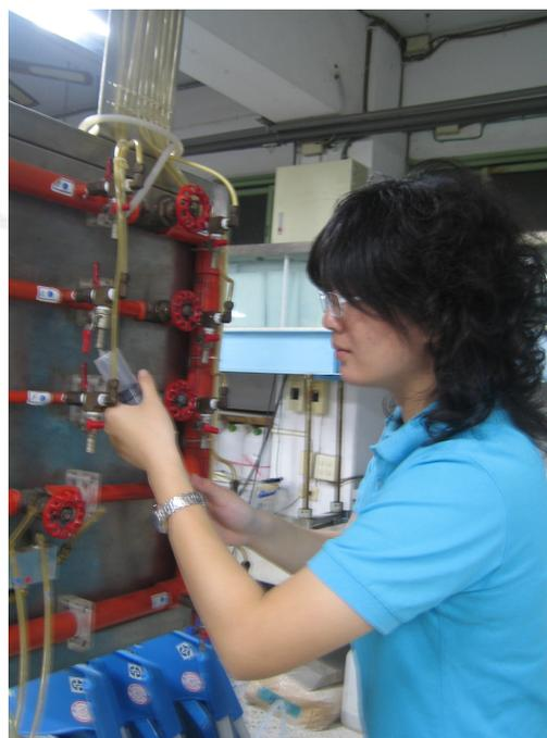
照片三 控制水閥門並吸除管中水份
