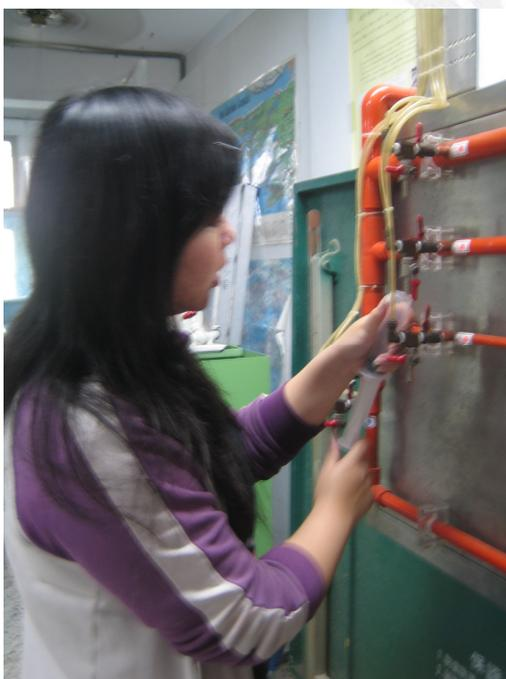
照片二 控制水閥門並吸除管中水份
