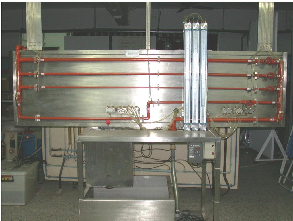
圖一 管路系統水頭損失試驗儀
