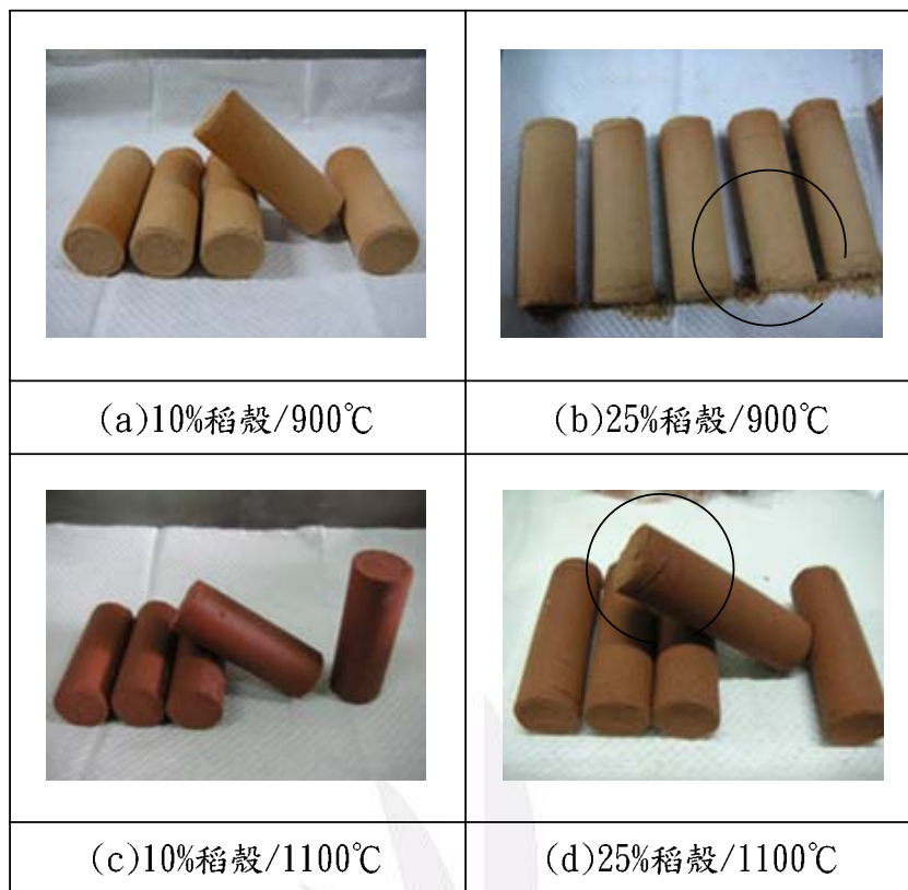
圖 4-8 添加稻殼試驗之燒結試體照片
