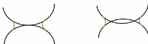
圖1 表面擴散(左圖)、體擴散及晶界擴散(右圖)
