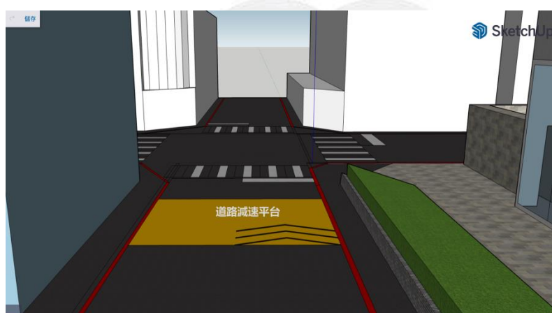
圖 六-4 文華路與西安街口設置道路減速平台的模擬示意圖
