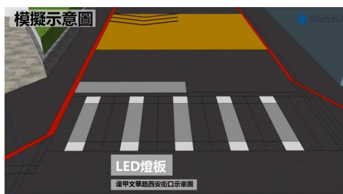
圖 六-1 文華路與西安街口設置 LED 行人穿越線的模擬示意圖
