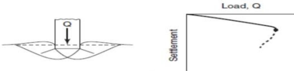
a 全面剪力破壞型式
