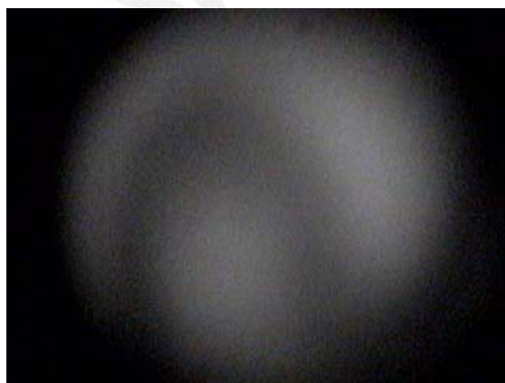
圖 2-6 平整度為一個波長之 BK7 基板的干涉圖
