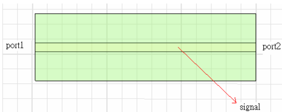
圖 4-21 典型傳輸線帶透視平面圖
